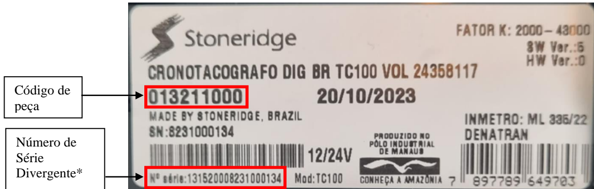
Figura 1: Etiqueta com divergência no número de série
