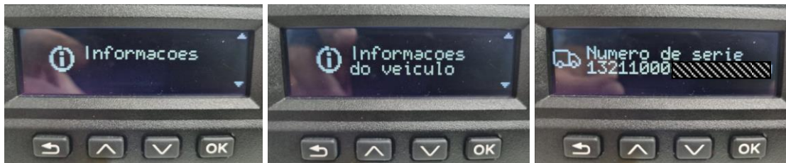
Figura 3: Consulta de número de série no menu de uso do cronotacógrafo TC100
